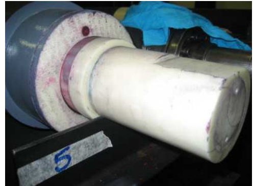
Achsisolierung nicht zulässig im EX-Bereich
